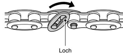
5. Lockern Sie die Kette und setzen Sie den Stift in das Loch ein.
