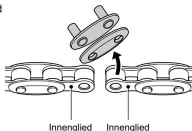
2. Setzen Sie das Verbindungsglied mit dem QUICKLINK- Stift wie in der Abbildung gezeigt ein.
